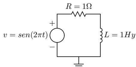
Planteando la malla correspondiente se puede obtener la ecuación del circuito de la figura:
